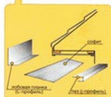
Софиты для подшивки карнизных и фронтальных свесов
